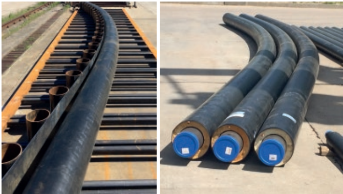
Tiesių izoliuotų vamzdžių lenkimas
