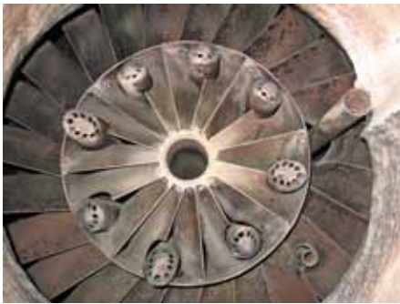
3 pav. Optimaliam darbui suderinto degiklio vaizdas kūrykloje
