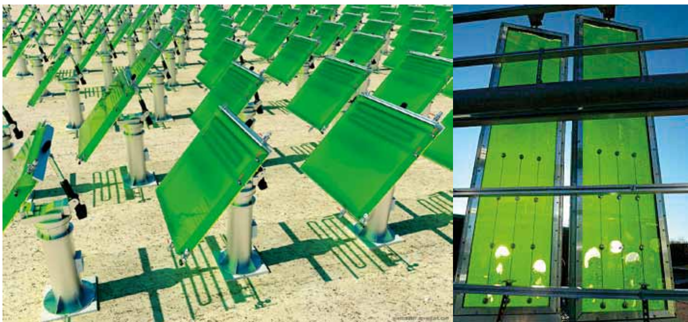
3 pav. Stiklinės plokštės-akvariumai, skirti dumbliams auginti
